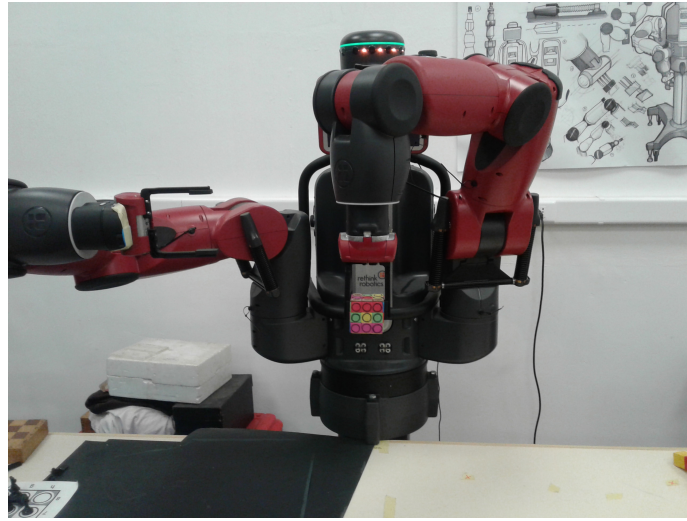
Figura 3.7: Posición y orientación al recoger el cubo. Los grippers tocan las caras L y R .
