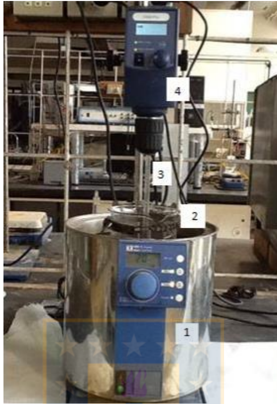
Figura 7: Equipo montado para las isotermas de extracción y re-extracción. (1) Baño termostático, (2) Reactor de 1L, (3) Impulsor con 4 aspas de vidrio, (4) Agitador mecánico.
