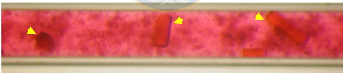
**Figura 24.** Cristales de R-ficoeritrina, señalados por cabezas de flechas, formados mediante la técnica contradifusión capilar. Diámetro interno del capilar 0,33mm. Fuente: Elaboración propia
