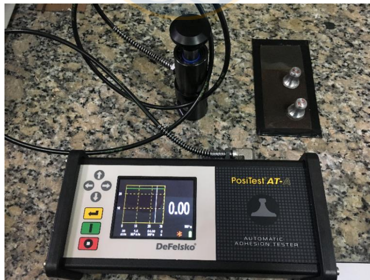
Figura 13. Dispositivo de ensayo de Adherencia Positest
