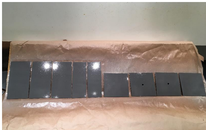
Figura 25. Placas pintadas de formulación 2% ZnO-NPs-func
