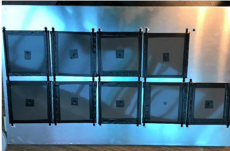
Figura 26. Montaje de probetas para ensayo de abrasión/embutición.
