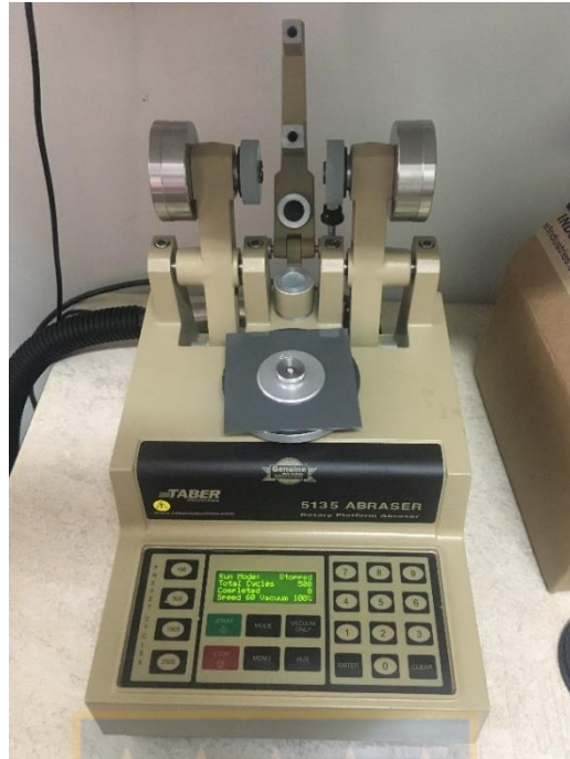
Figura 10. Máquina para ensayo de abrasión Taber
