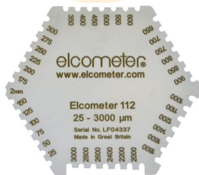
Figura 8. Peine hexagonal para medición de espesor película húmeda
