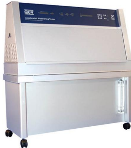
Figura 7. Cámara de Intemperismo acelerado QUV/Spray
