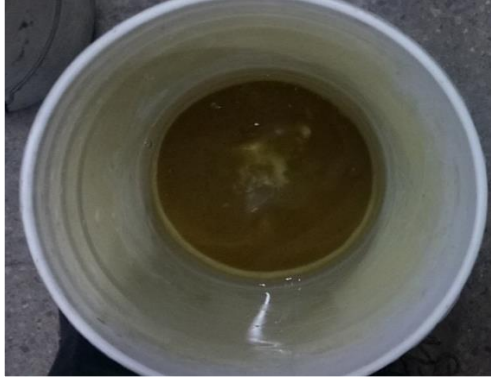
Figura N° 40 Sólidos sedimentados muestra de agua haulage.
