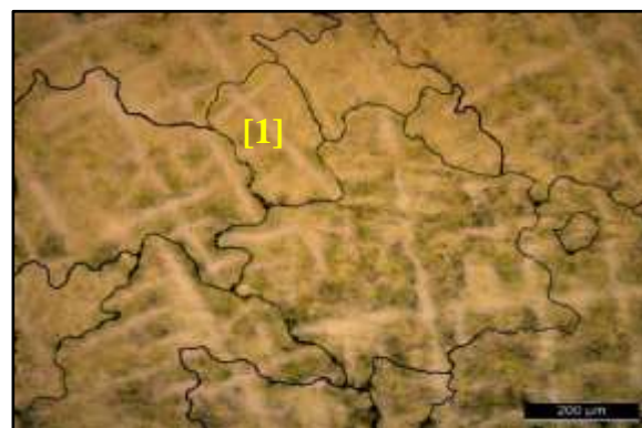
Figura 25.- Fotomicrografía de probeta sin deformación con tratamiento térmico a 1180°C por 1 hora. Ataque químico V2A. Aumento x100. [1] Grano de austenita.
