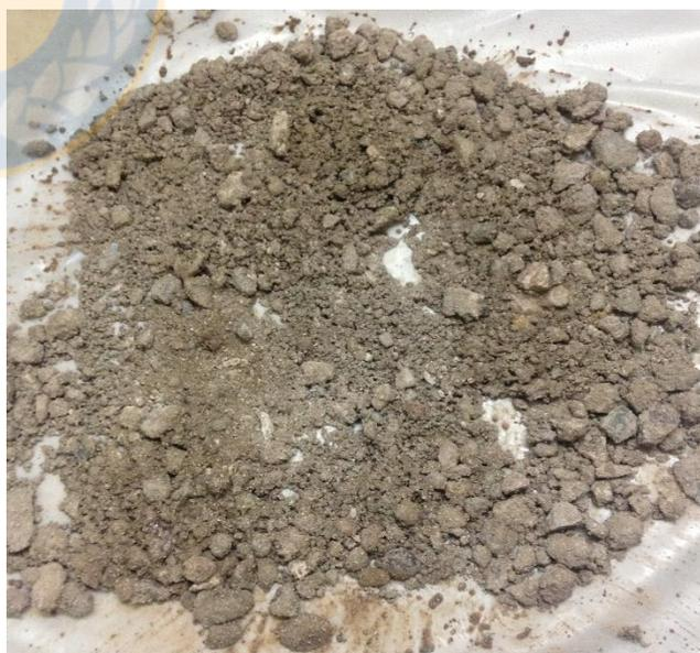
*Figura 33: Curado con agua destilada después de 72 horas.*
