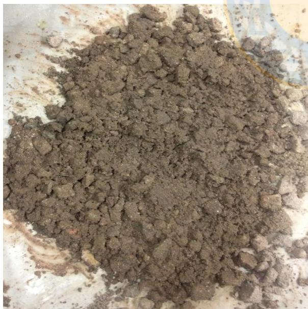
*Figura 32: Curado con agua de mar después de 72 horas.*
