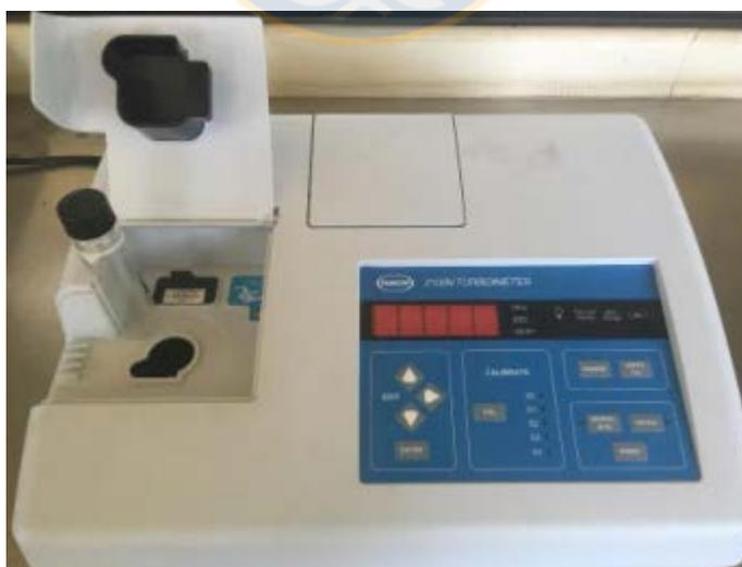
Figura 16. Turbidímetro HACH 2100 N.
