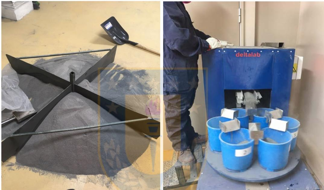
Figura 10. Roleo y cuarteo manual del mineral concentrado Cu - Mo y cortador rotatorio (deltalab) para obtener muestras homogéneas.
