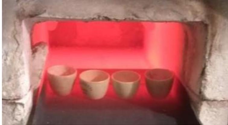
Figura 10: Calcinación de muestras en crisol.  $T^{\circ} = 820^{\circ}\text{C}$
