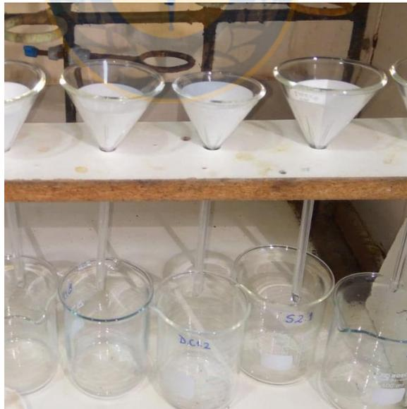
*Figura 8: Filtración en caliente de muestras*
