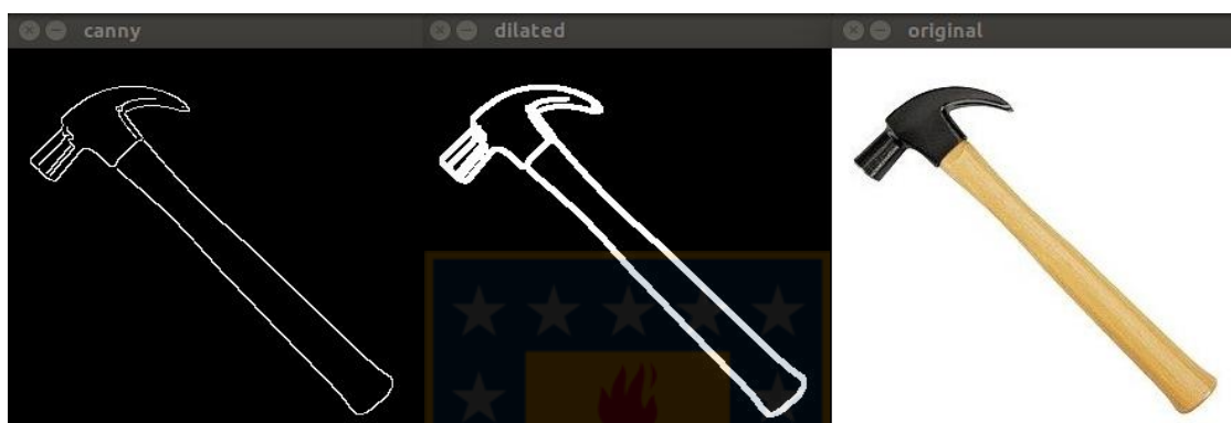
Figura 4: Diferencias entre los bordes detectados: Canny (izquierda), Canny con bordes aumentados (centro), imagen original (derecha)
