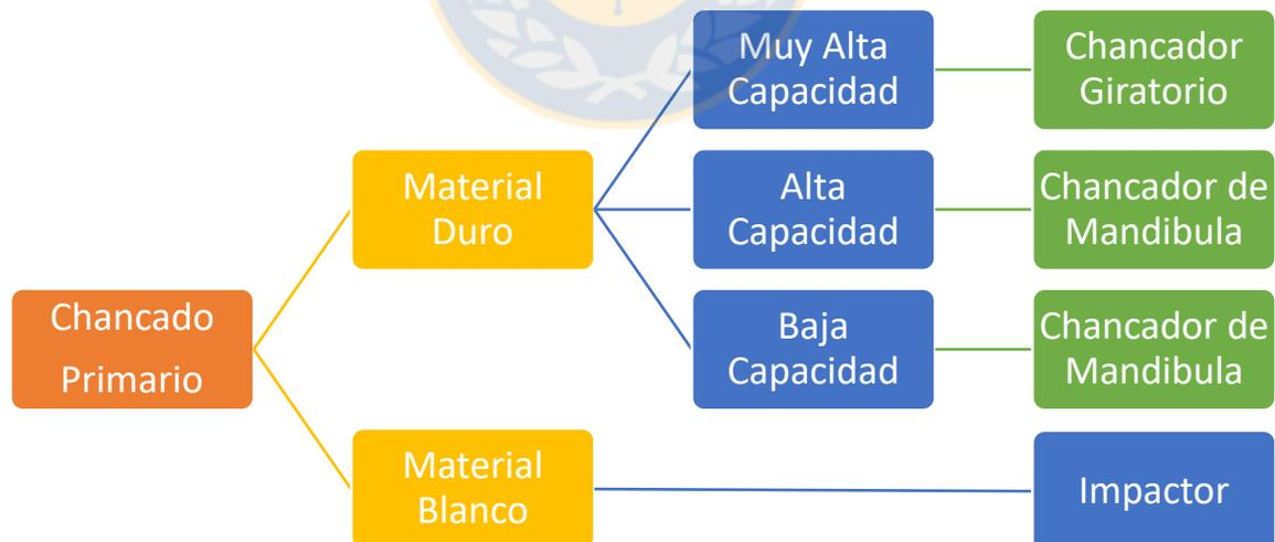
**Figura 42** Esquema general de equipos utilizados en chancado en función de la capacidad y dureza del material
