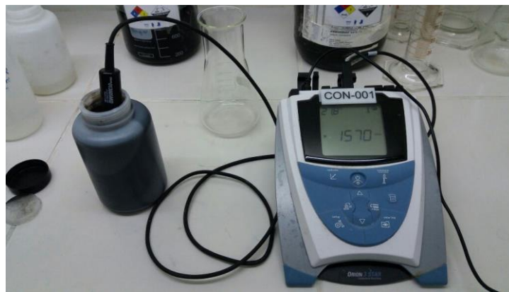
Fig. 5.3 Medición de la conductividad del lodo del tratamiento secundario.
