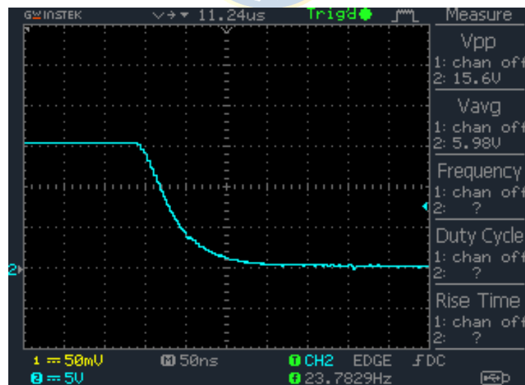
Fig. 7.13 Fall time pulso de descarga en el gate del IXGK28N140B3H1; Voltaje CH2 (azul), 5V/div; Time 50ns/div.
