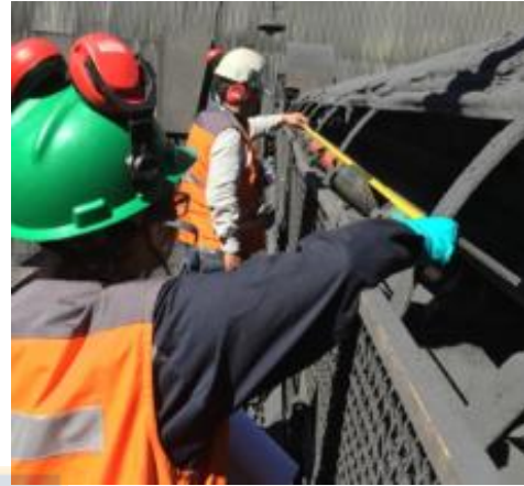
Figura 46: Medición de una longitud determinada en la correa para el cálculo de velocidad.
