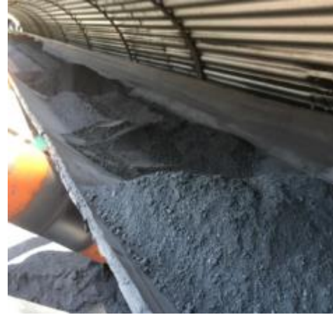
Figura 50: Separación de material de corte de metro.
