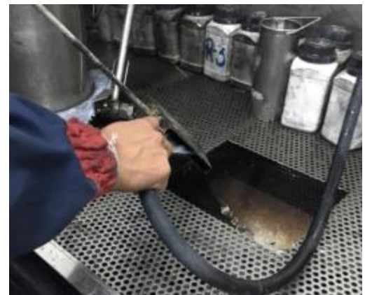
Figura 36: Lavado de cortador de muestras para densímetro
