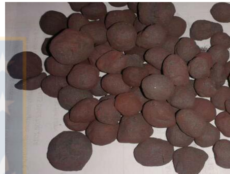
Figura 3: Pellets para reducción directa [4].
