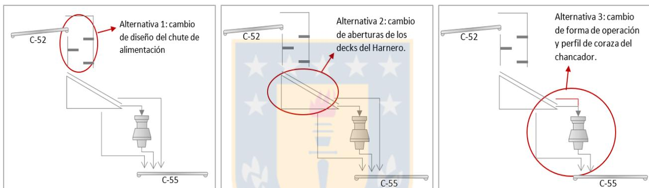
Figura 22. Esquema de las diferentes alternativas de cambios.
