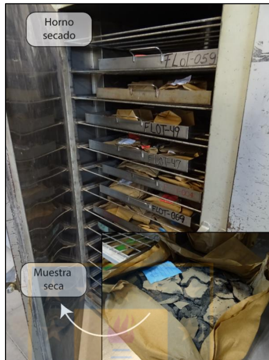
Figura 5.15: Horno de secado y muestra seca después del secado.
