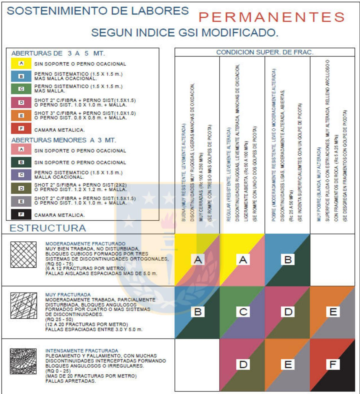
Figura 17: Adaptación del GSI para definir sistemas de refuerzo y/o soporte para labores permanentes.
