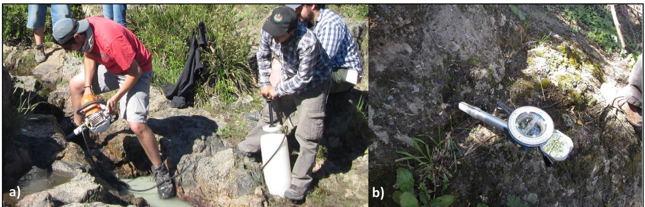
Fotografía 5.2: a) proceso de extracción de testigos por medio de una perforadora portátil con lubricación por agua. b) Orientación de las muestras in situ con un inclinómetro y compás magnético.
