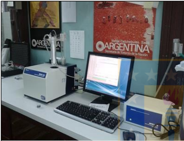
Fotografía 5.3: Equipo Kappabridge MFK1-FA (Agico) ubicado en el Laboratorio de Paleomagnetismo y Geomagnetismos del Instituto de Geociencias Básicas, Aplicadas y Ambientales de Buenos Aires (IGEBA).
