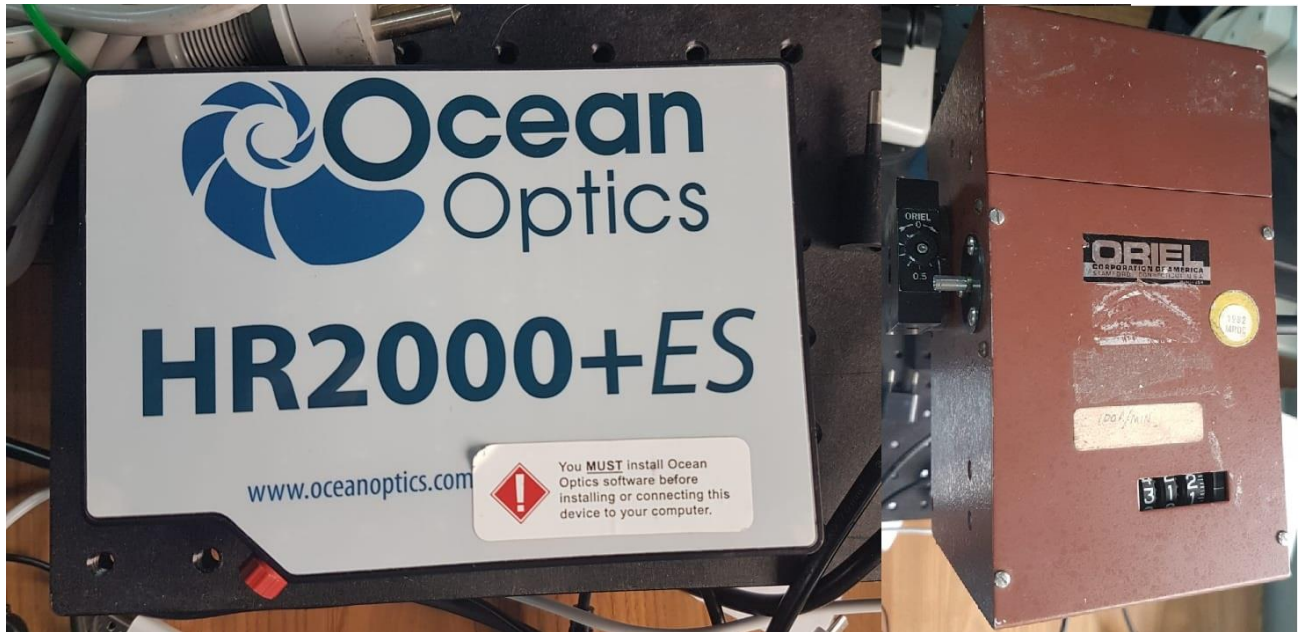
Figura 3.2: izquierda: espectrómetro Ocean Optics HR2000+ES, derecha: monocromador Oriel 7240
