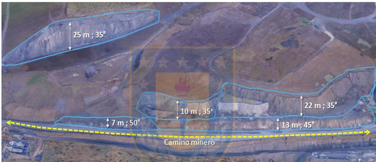
Figura 4.11: Relación de altura/ángulo de talud en pared norte de Botadero Sur.
