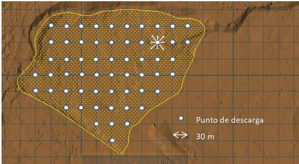
Figura 4.22: Puntos de descarga de suelo sobre área a rehabilitar
