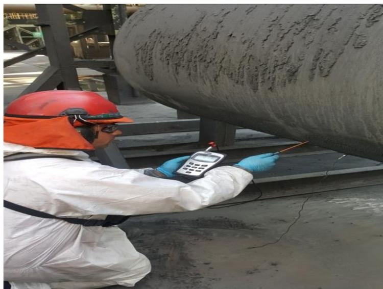
Figura 21. Medición de campo magnético con gaussometro.
