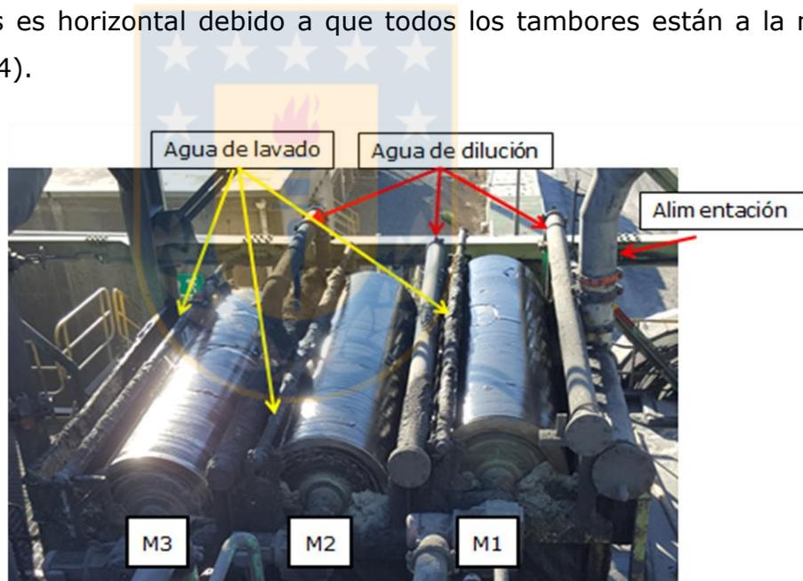
Figura 13. Estructura de la línea Eriez (línea 4).
