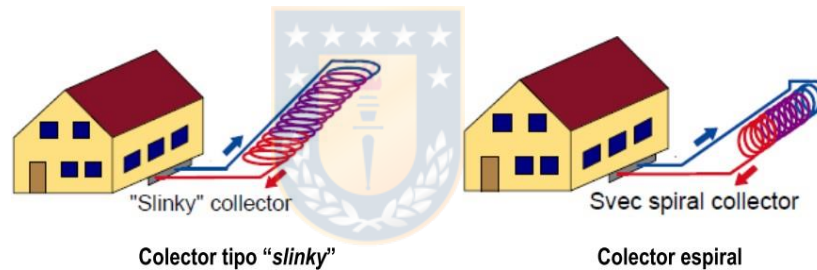
Figura 2.9 Sistemas cerrados con intercambiadores horizontales slinky . Fuente [24]
