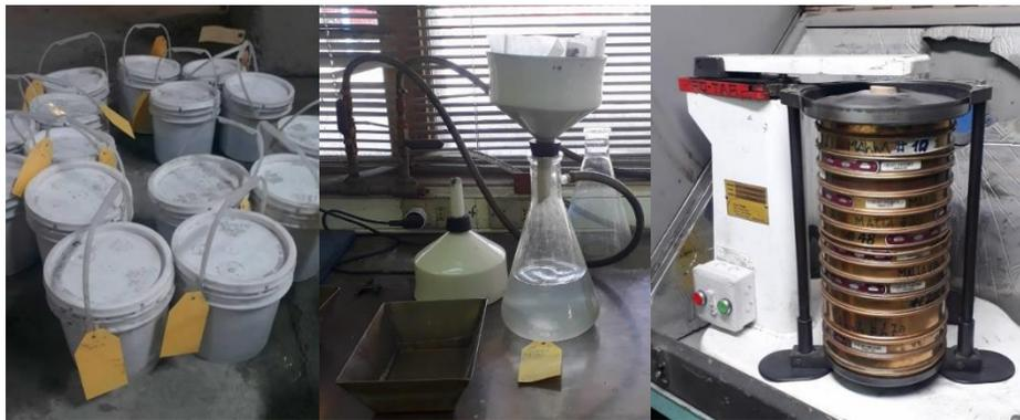
*Figura 4.3 Etiquetado de muestras, filtrado en vacío y tamizaje por tamaños.*
