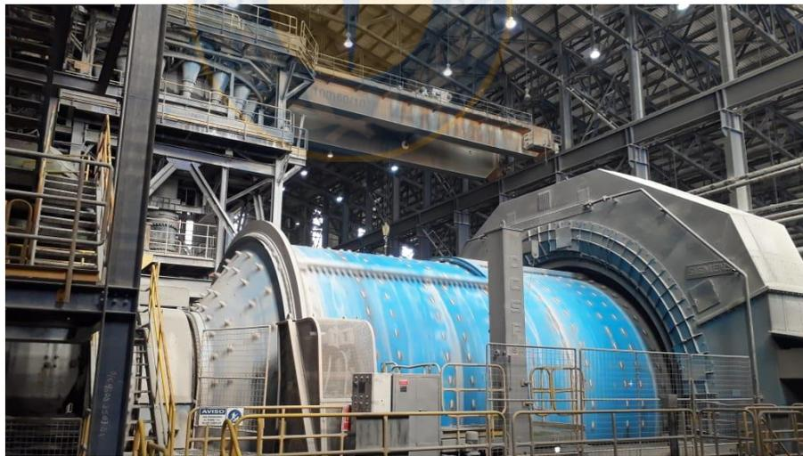
Figura 3.4 Molino de bolas 512 planta SAG2, División El Teniente.
