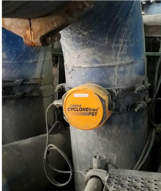
Figura 4.1 Sensor PST implementado en ciclón 4, BHI512.
