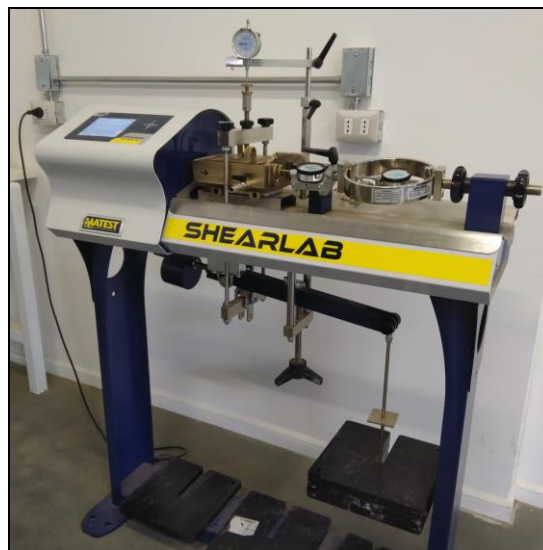
Figura 3.12: Equipo de corte MATEST SHEARLAB S276 utilizado.
