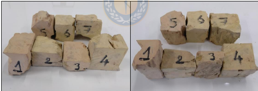
Figura 3.6: Muestras para ensayo de compresión uniaxial.
