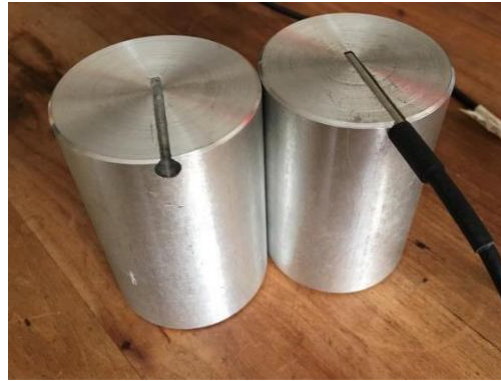
Figura 16: Surco confeccionado en los cilindros de Duraluminio 2011 para el posicionamiento de los sensores dentro del sistema.
