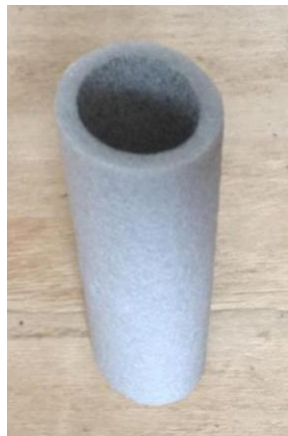
Figura 8: Tubo de espuma de polietileno (aislante térmico).
