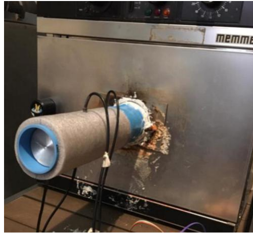
Figura 19: Disposición final de los componentes del experimento para testigos de roca.
