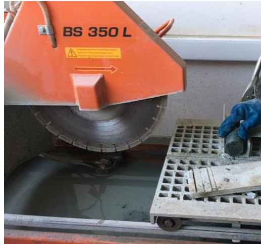
Figura 12: Procedimiento de ajuste del espesor de la muestra.
