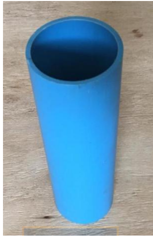
Figura 7: Tubería de PVC de 5 cm de diámetro interno.
