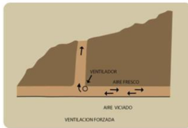
Figura 17: esquema de circuito de ventilación forzada [12].
