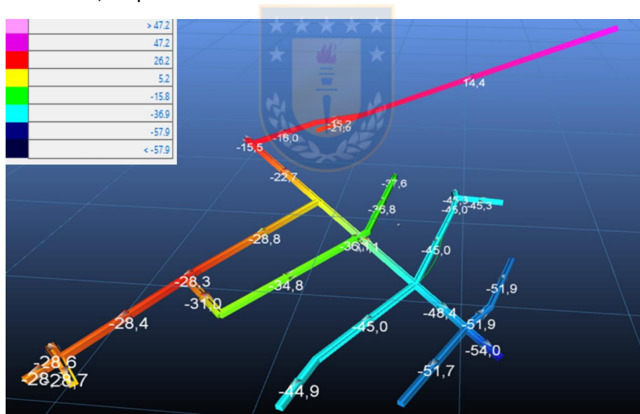
Figura 38: modelo de líneas tridimensional importado a VentSim™.
