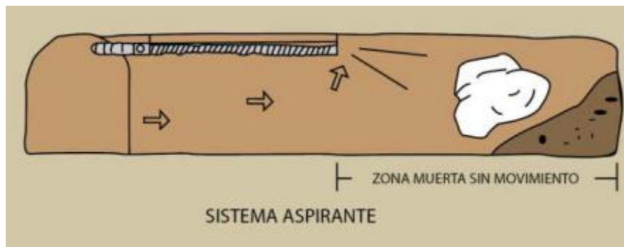
Figura 19: esquema de sistema de ventilación auxiliar aspirante [12].
