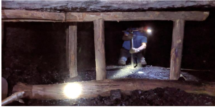
Figura 9: sostenimiento en una veta de baja potencia.
