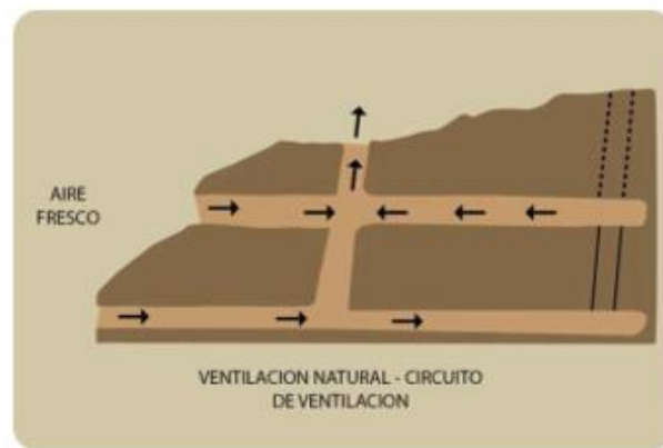
Figura 16: esquema de circuito de ventilación natural [12].
