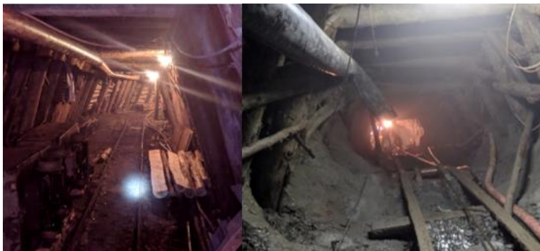
Figura 3: ejemplo de maestra (izquierda) y chiflón (derecha).
