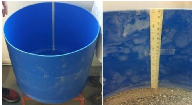
Figura 4: Barril de polietileno de 200 litros cortado a la mitad y graduado en su borde con una cinta métrica.
