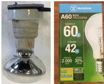
Figura 5: Lámpara de 42 W de potencia con portalámparas de loza.
