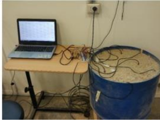
Figura 8: Unidad de almacenamiento de datos (ordenador portable).
