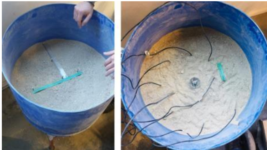
Figura 13: Disposición de los sensores y la fuente de calor según el modelo planteado.
