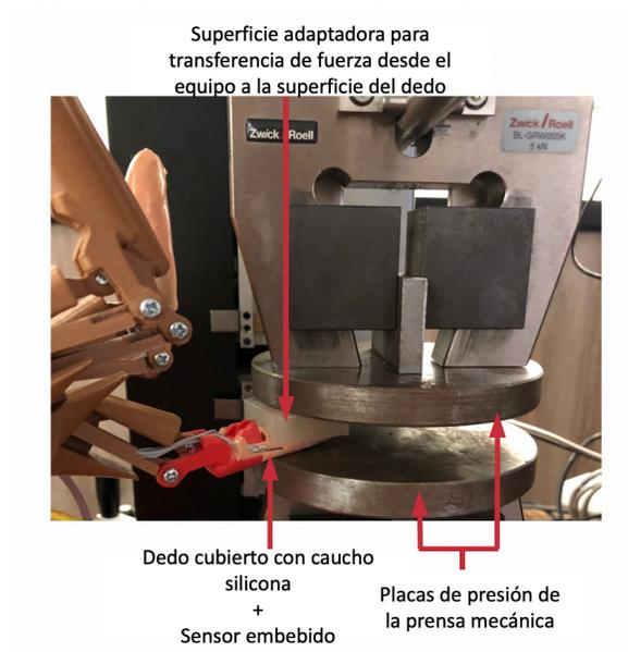
Figura 6.6.- Banco de ensayos con equipo ProLine Table-top Z005 Zwick/Roell, dedo de prótesis con sensor capacitivo embebido en caucho silicona entre placas de ensayo de fuerza.
