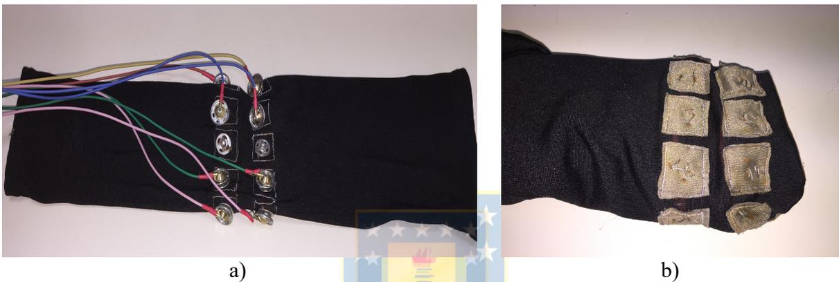
Figura 4.3.- Arreglo de electrodos textiles en manga elasticada.
