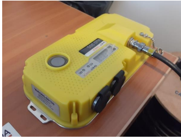
Figura 25: Cable conectado al equipo ShotTrack
