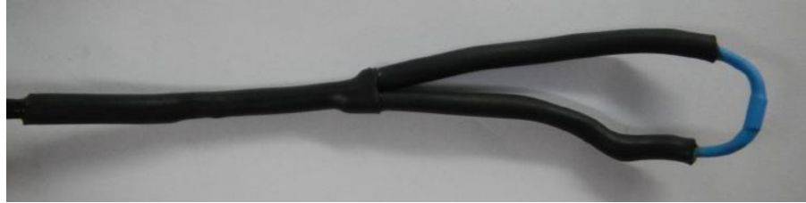
Figura 41: Sensor de presión con resistencia de carbón terminado
