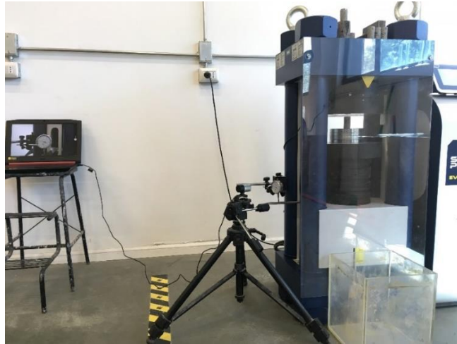
Figura 22. Equipos para medición de UCS y deformación de la Universidad de Concepción.
