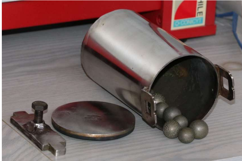
Fig. 9. Molino de bolas de acero al carbono utilizado en los experimentos (Fuente: elaboración propia).
