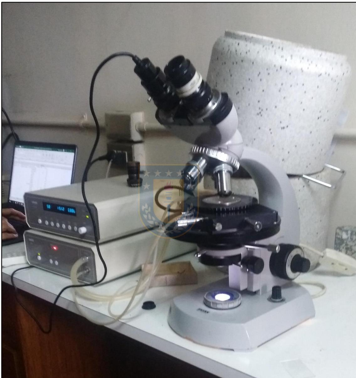
**Figura 1.2.** Equipos del laboratorio de microtermometría del Departamento Ciencias de la Tierra, Universidad de Concepción. Platina de calentamiento y enfriamiento Linkam THMS600 (montada en el microscopio); controlador de temperatura Linkam TP92 (izquierda arriba); bomba de nitrógeno Linkam LNP1 (izquierda abajo).
