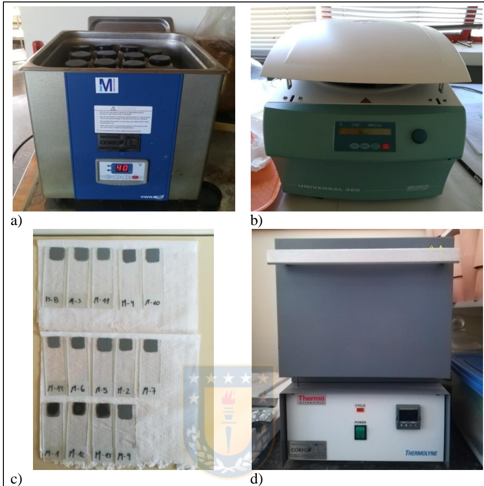
Figura II.9 a) Equipo de ultrasonido marca Merck Millipore modelo USC 900T b) Centrifuga marca Hettick modelo Universal 320. c) Montaje preliminar de sección fina en portaobjeto. d) Horno tipo mufla marca Thermo modelo FD1535M.
