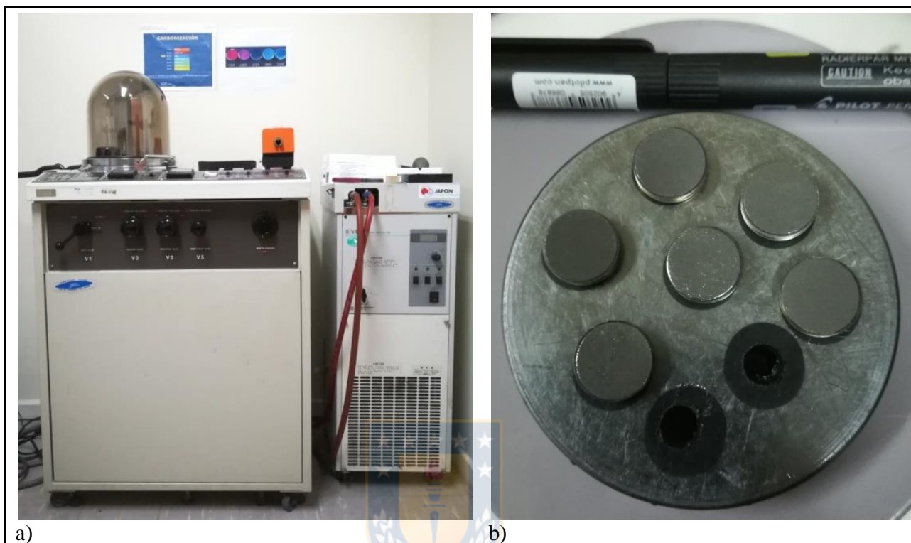
Figura II.8 a) Carbonizador de sedimento para análisis SEM marca JEOL modelo JEE-4X. b) Montaje de sedimento carbonizado para SEM en pin metálico.
