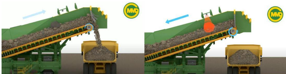
Figura 12: Situación de presencia de un bolón en correa de traspaso de material [21].
