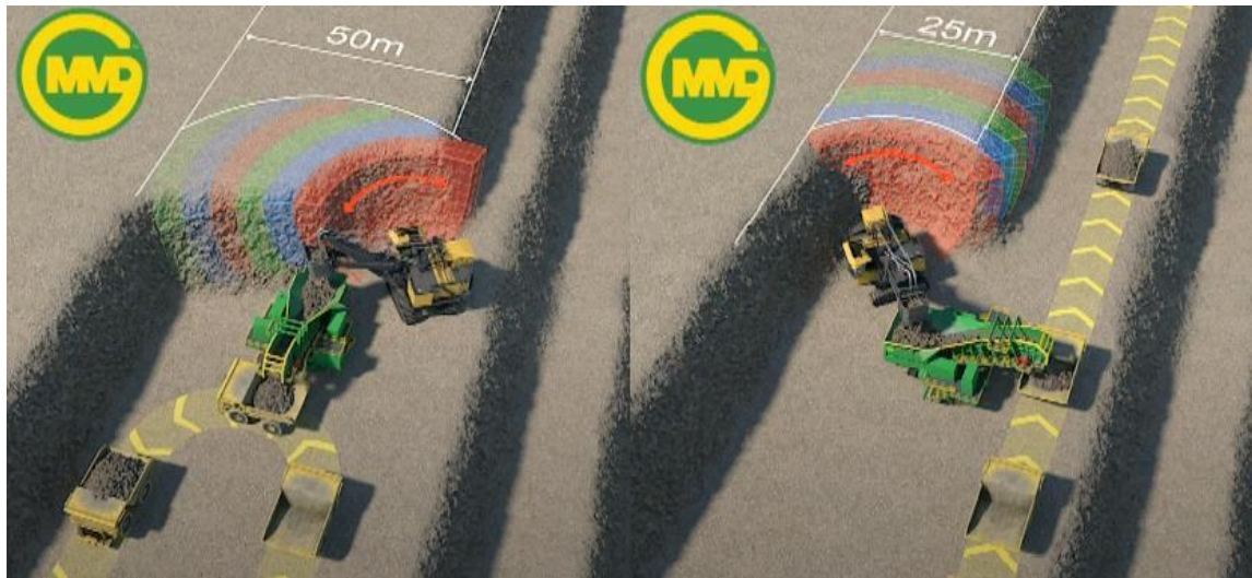
Figura 15: Rutas de carga con el surge loader. [21]
