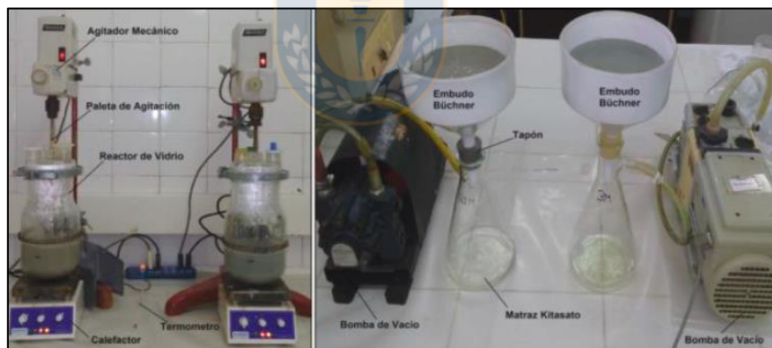
Figura 2.4. Montaje experimental. A la izquierda se muestra el montaje de lixiviación y a la derecha el montaje de filtrado.
