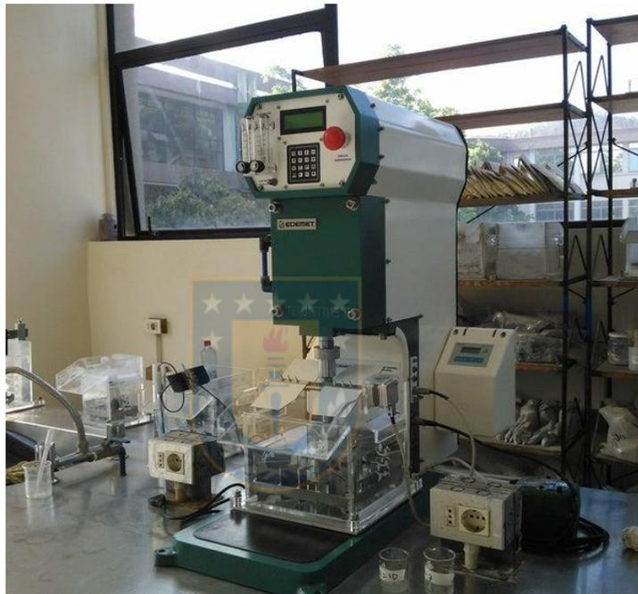
Figura 17. Celda de laboratorio EDEMET con sus componentes (Fuente: Elaboración propia)
