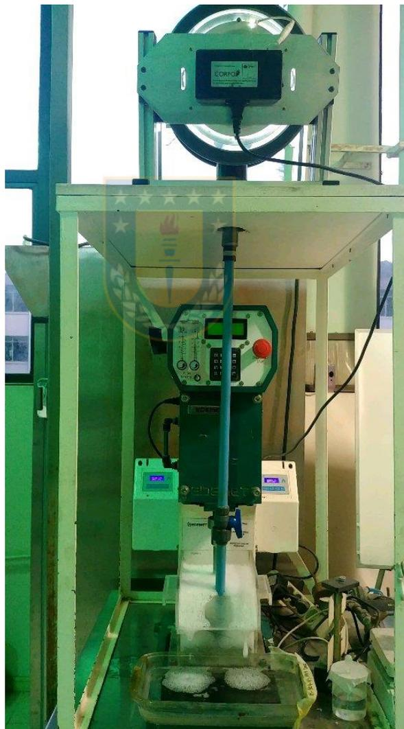
Figure 18. Esquema del sistema Medidor de burbujas (Fuente: Elaboración propia)
