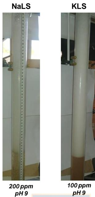
Figura 30. Espumas obtenidas utilizando diferentes lignosulfonatos (NaLS y KLS) (Fuente: Elaboración propia).
