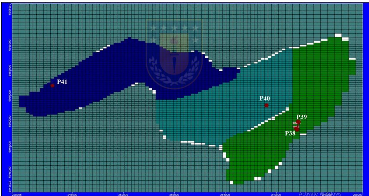
Figura 3.8. Conductividad hidráulica asignada en Visual MODFLOW para la microcuenca N°17 en la capa 1. Los puntos de color rojo simbolizan la ubicación aproximada de los pozos (elaborado por Silvana Leiva Torres).
