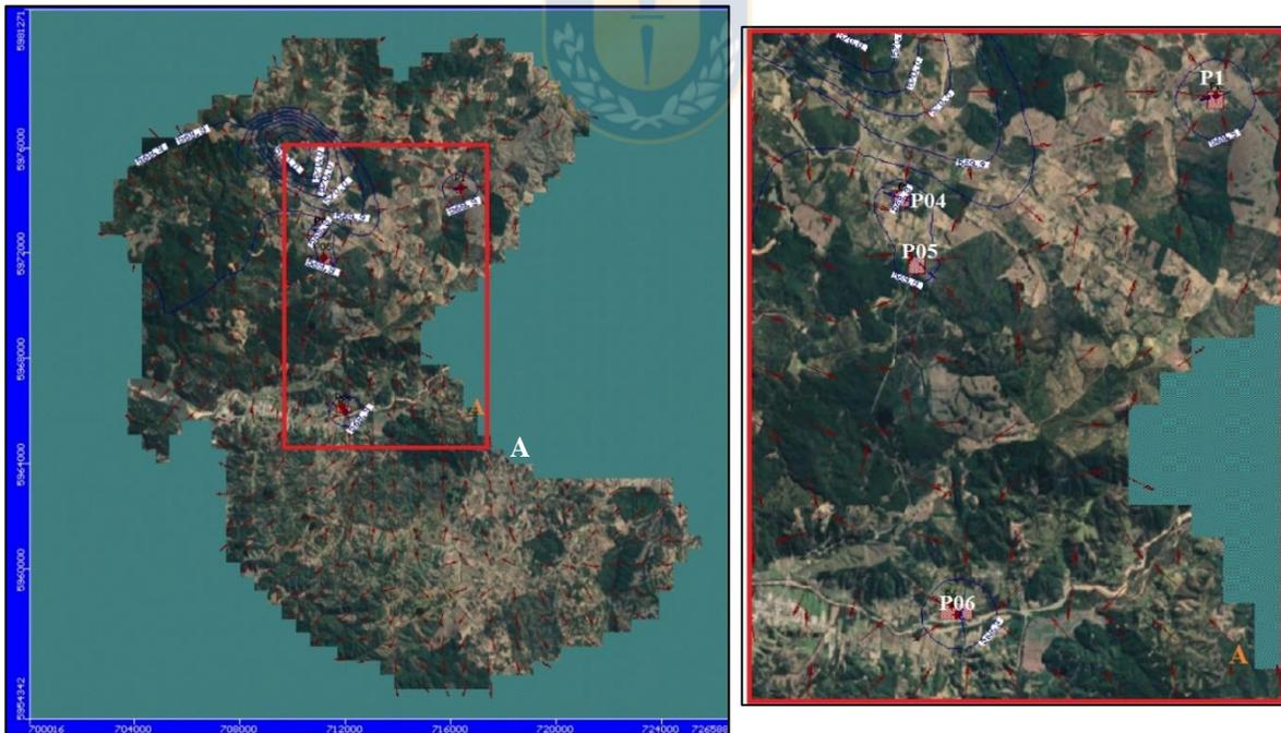
Figura 3.16. Vista en planta de la dirección de flujo de Mc-62. A. Acercamiento a pozos, donde se aprecia la extracción sobre el acuífero y el flujo (elaborado por Silvana Leiva Torres).
