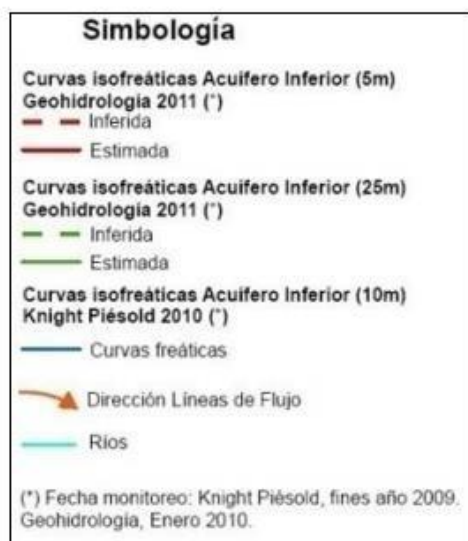
Figura F- 1: curvas equipotenciales del acuífero inferior en sector RT [30]
