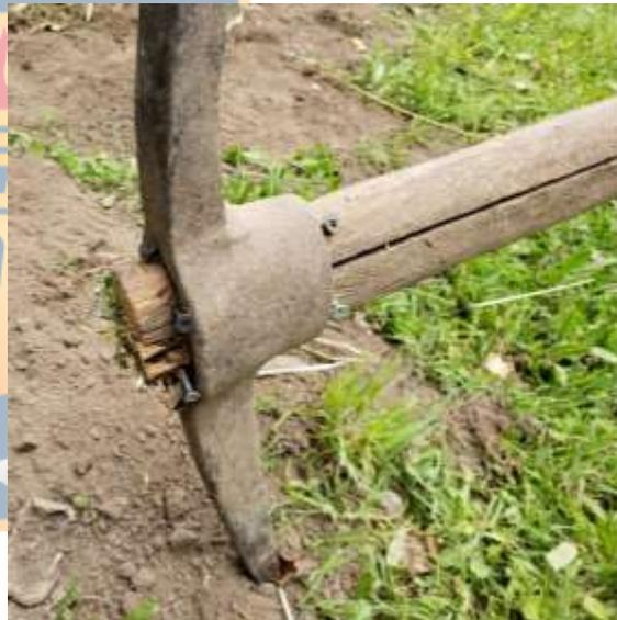
Se muestra diferentes herramientas en condiciones de alto riesgo para el personal, herramientas con cables eléctricos al descubierto sin su correspondiente protección, y herramientas manuales rudimentarias para las tareas (excavación para instalación de tuberías con cableado).
