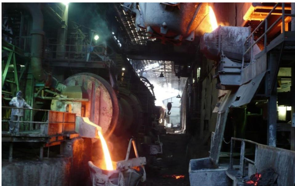
**Figura 3. 3** Descarga de escoria del CT (izquierda) y alimentación al HE (derecha), Paipote, 2008.
