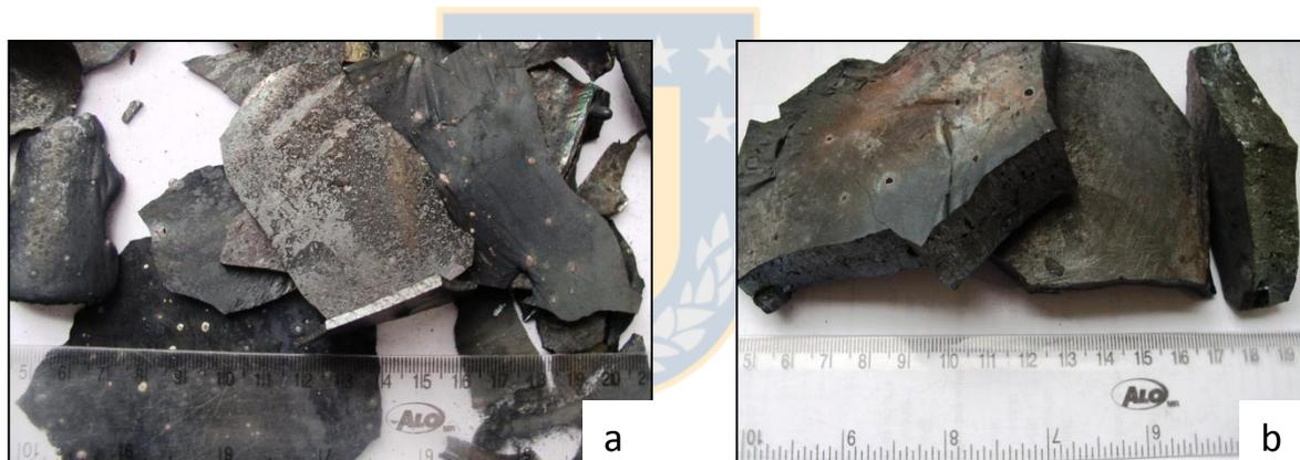
**Figura 4.17** Aspecto de especímenes antes de pulido, muestras escoria CT a) tipo A y b) tipo B (Paipote, 2009).
