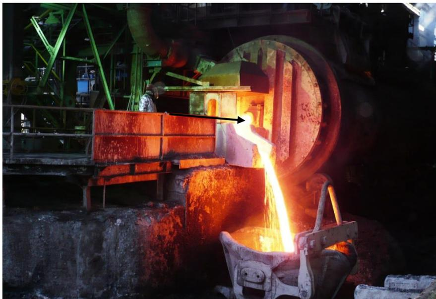
**Figura 4.2** Muestreo de escoria fundida del CT (Paipote, 2008)
