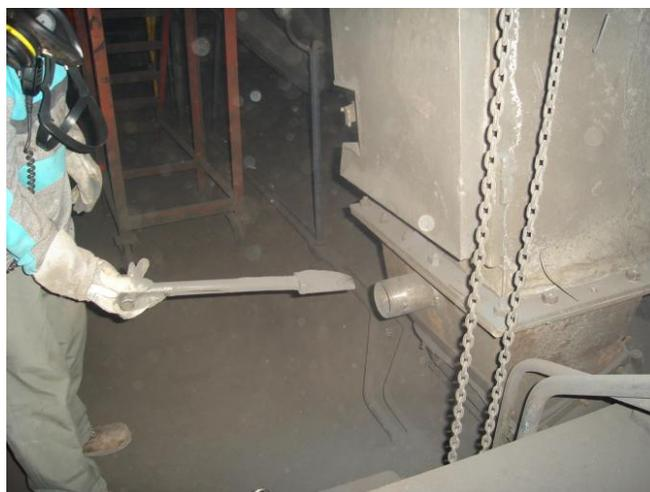
**Figura 4.15** Muestreo de carga seca alimento del HFF (foto cortesía de Chagres, 2009)
