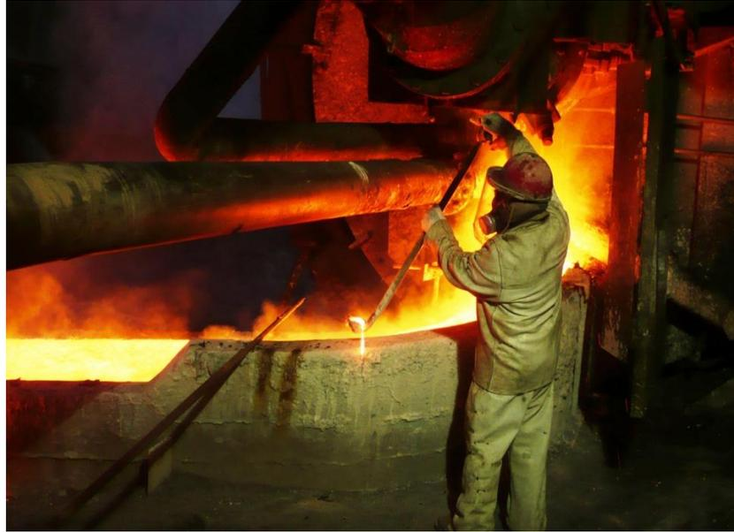
**Figura 4.5** Muestreo de mata fundida en la canal de descarga del CT (Paipote, 2008)
