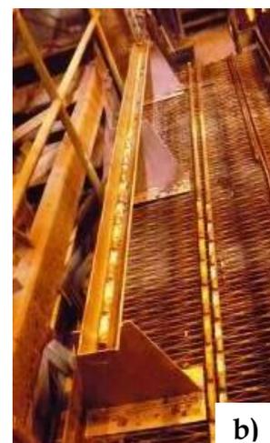
**Figura 4.10** Sondaje del baño del HLT #2(Chagres, 2009). a) Toma de muestra b) Sonda graduada.
