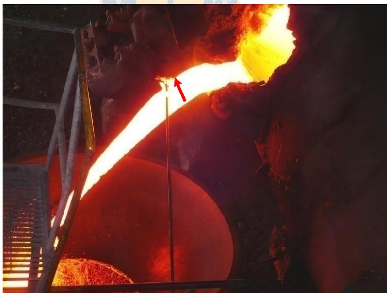
**Figura 4.13** Toma de muestra en la descarga del HLT #1(Chagres, 2009)
