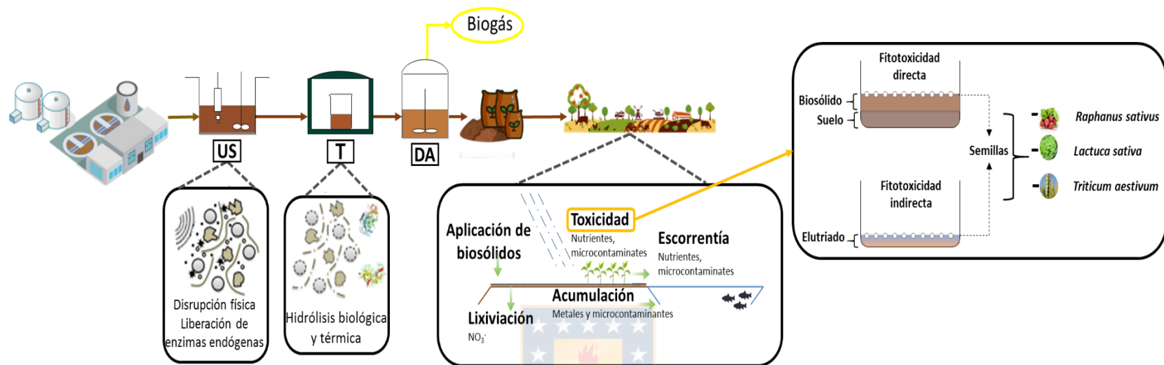
Figura 1. Diagrama del proceso de digestión anaerobia avanzada evaluado en esta investigación. US: pre-tratamiento de ultrasonido; T: pre-tratamiento térmico; DA: digestión a anaerobia.
