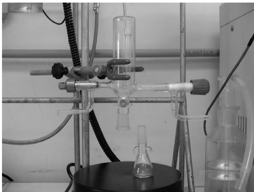
Figura 15. Sistema de reducción in situ .
