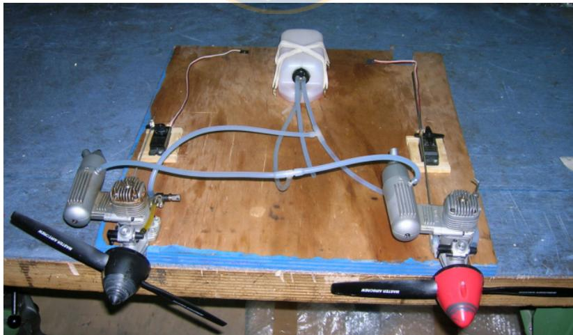
**Figura 2.7:** Plataforma de experimentaciones bimotor con motores a combustión.
