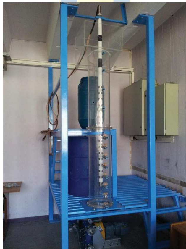
Fig. B.3 Instalación en terreno de la columna de sedimentación y sonda tomográfica.
