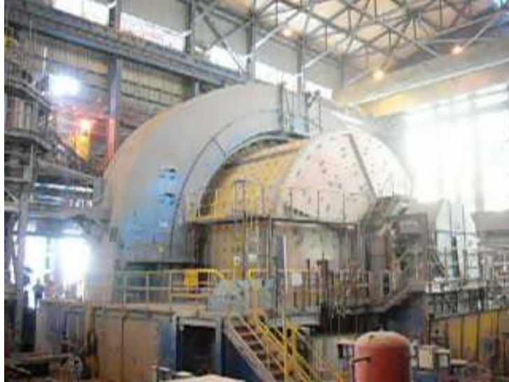
Figura 2.2: Molino SAG perteneciente a la planta SAG1 del Concentrador Colón
