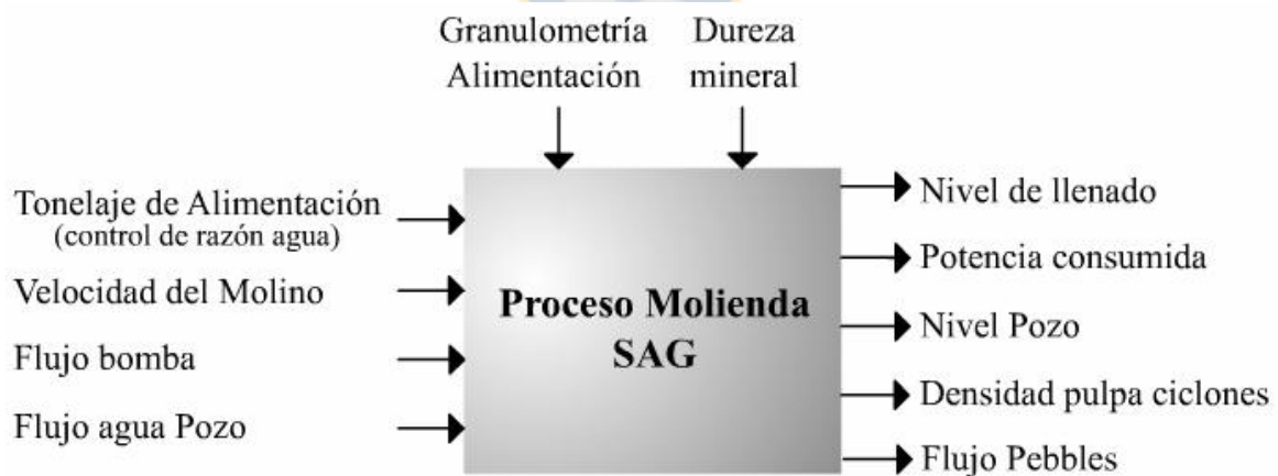
Figura 6.2: Proceso de molienda SAG considerado como un sistema MIMO de 4x4
