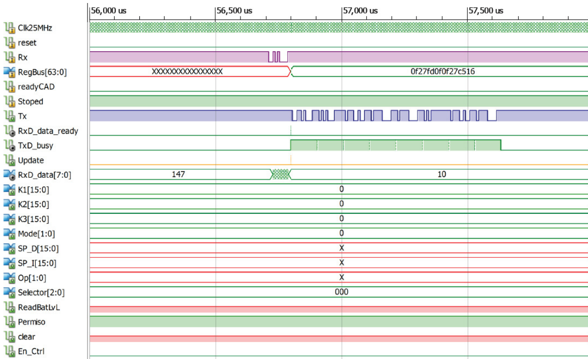
FIGURA 7.7 Resultado de simulación del módulo de Comunicación – Lectura del Acelerómetro.
