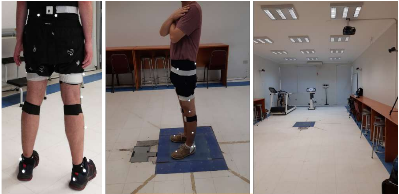
Fig. 5.21: Ubicación de los marcadores infrarrojos para la realización de las pruebas de análisis de marcha usando un laboratorio de captura de movimiento optoelectrónico.
