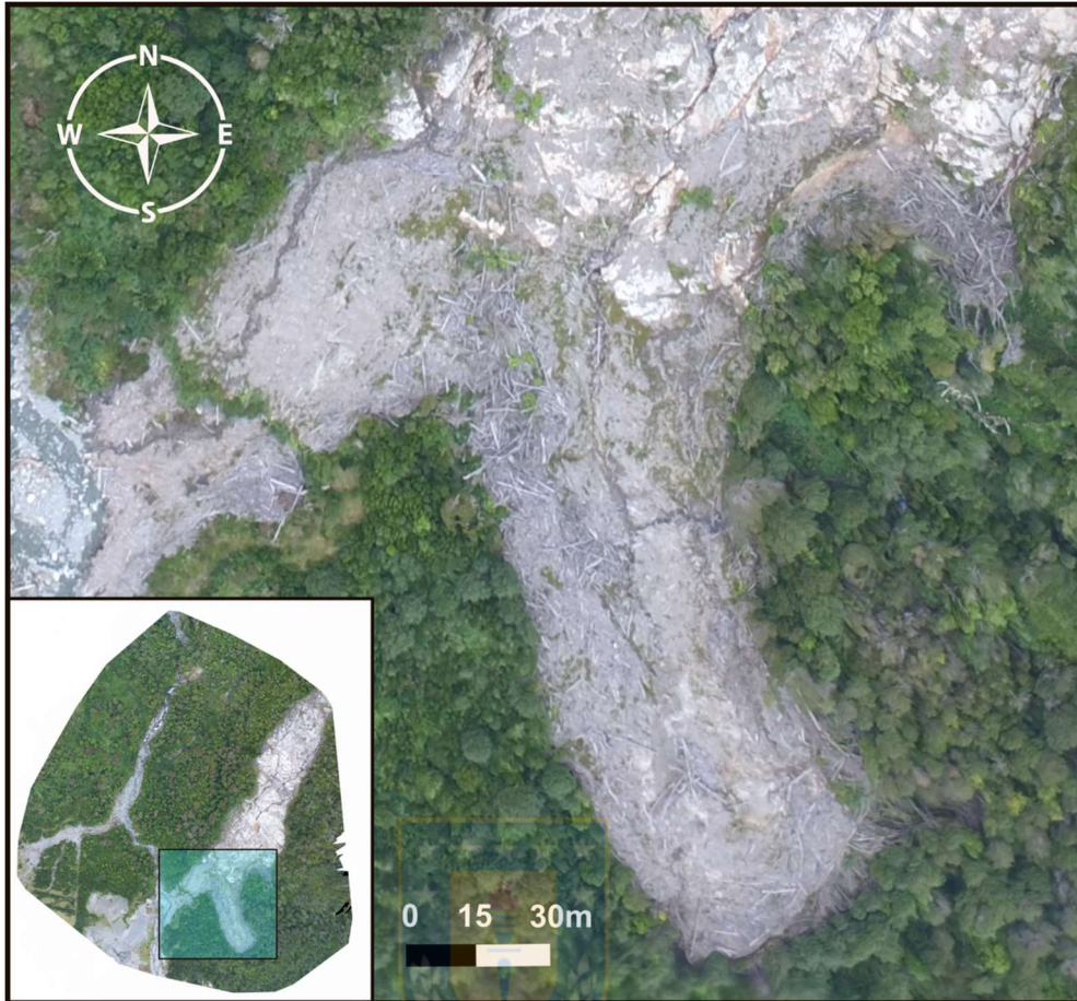
Figura 5.4: Ejemplo de depósito de deslizamiento. Fotografía aérea del deslizamiento “Schilling”, en la cual se encuadra la zona de depósito principal que exhibe una morfología de “lengua” y es posible apreciar los diques formados por los troncos de árboles removidos, transportados y depositados de forma fluidizada, posicionándose a modo de “levees” en los bordes del depósito. Esto se presenta en todos los deslizamientos de la zona.
