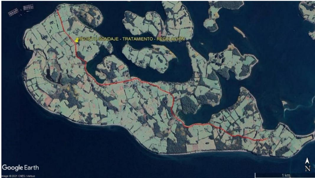
**Figura 33.** Imagen satelital. Sistema de Agua Potable Rural y red de distribución para la isla Añihue. Fuente: Dirección de Obras Hidráulicas.
