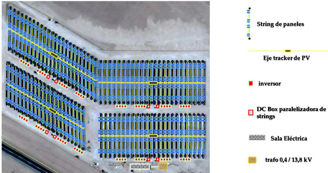
Fig. 3.2 Vista aérea de una planta fotovoltaica.
