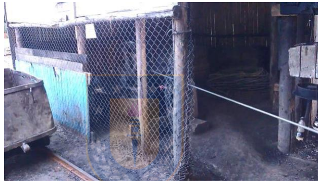
Figura 21. Sistema de acarreo de mina artesanal en Curanilahue (provincia de Arauco) formada por un winche y carros
